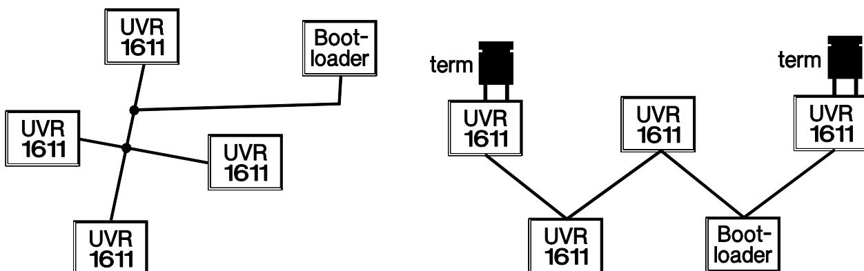
**Příklad:** Spojení tří síťových uzelů (NK) s 2x2pólovým kabelem a ukončovacím můstkem na krajních uzlech.
