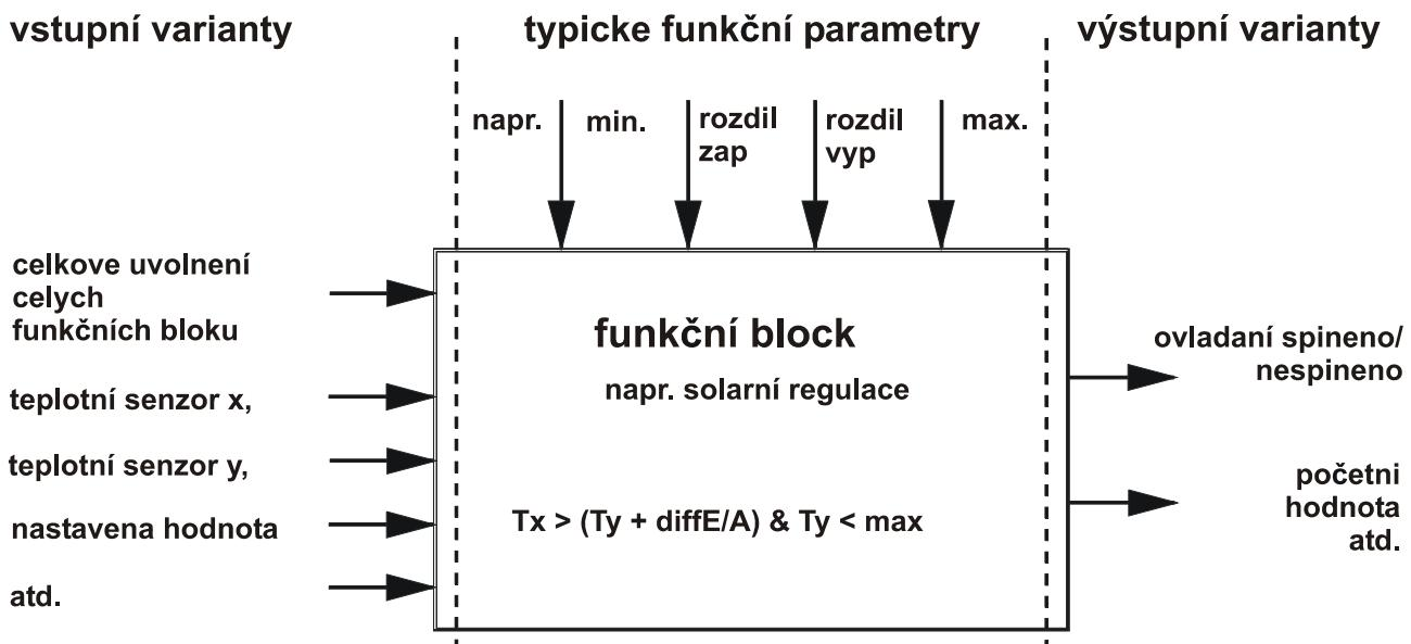
Přes vstupní varianty funkčních modulů obdrží modul všechny potřebné data k vnitřnímu rozhodování. Z velké části to jsou teploty. Dále obsazuje každý modul vstupní variantu „ovladaní spineno“, která může být použita jako generální povolení k práci s úlohami .
