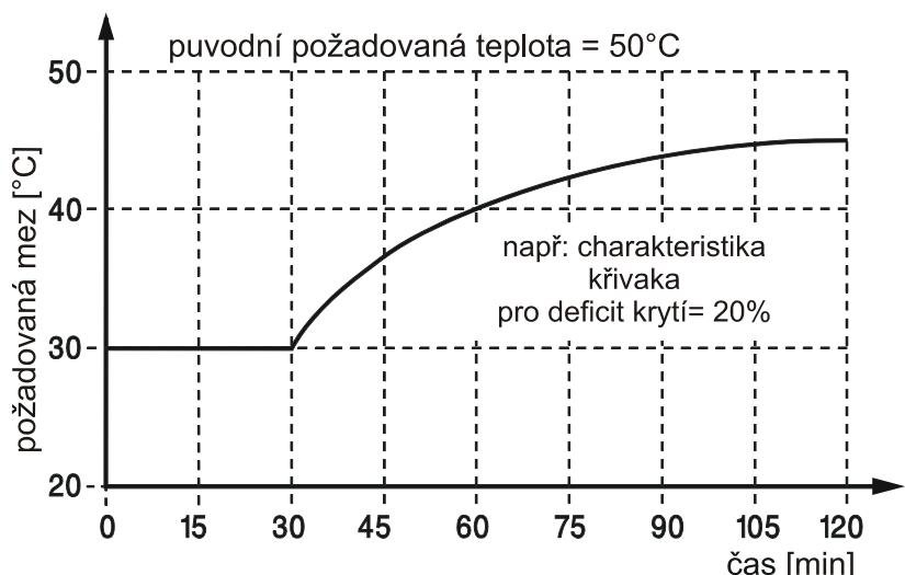
Tzn. bude stanoven požadavek, pokud pro 30 min je (skutečná)požadovaná teplota o  $20^{\circ}\text{K}$  nižší než nastavená hodnota nebo pro 1440 min (=1 den) (skutečná)požadovaná teplota o  $0,42^{\circ}\text{K}$  nižší než nastavená hodnota
