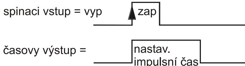
**Čas blokace:** ZAP- Signal na Trigger vstupu zapne výstup teprve, když uplyne doba časovače posledního ZAP- signálu.
