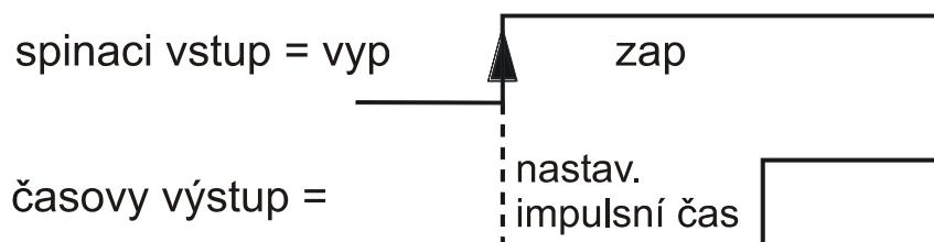
**Minimální doba běhu:** ZAP- Signal na Trigger vstupu zapne výstup okamžitě. Odpadne-li vstup během času časovače (VYP), zůstane výstup přesto zapnutý, do doby než uplyne času časovače.
