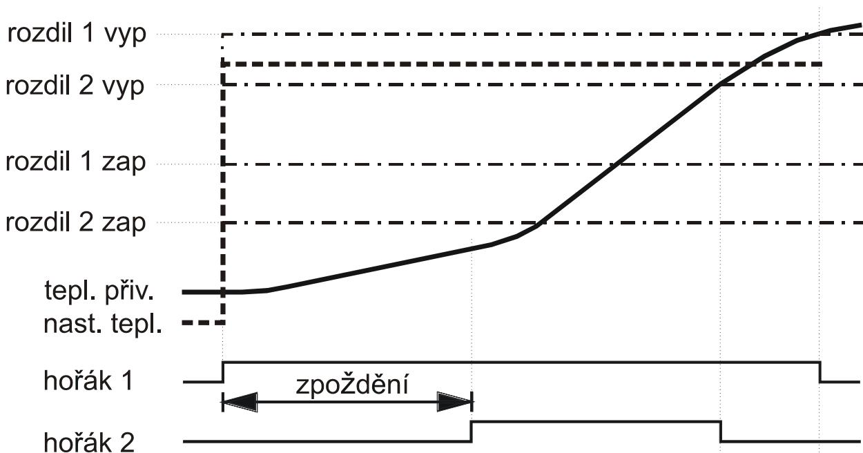
Když je požadavek na vstupní teplotu (např. skákavé stoupání jmenovité teploty) pod zapínací teplotou vedoucího kotle, bude nastaven první požadavek. Je-li po uplynutí nastavitelné časové prodlevy vstupní teplota pod spínací teplotou druhého kotle, bude nastaven druhý požadavek. Odstavení kotle se stane v pořadí, jak vstupní teploty překročí vypínací teploty.
