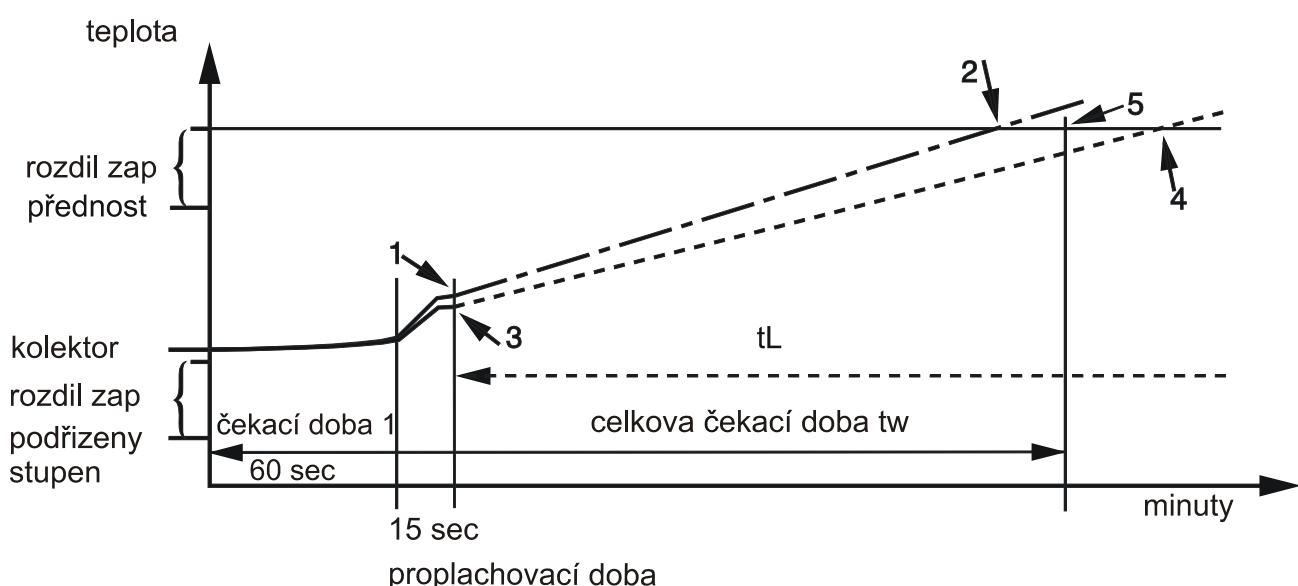
Přednostní Timer vyřadí čerpadlo na dobu čekání 1 (60 Sec). Po době proplachování (1,3) spočítá počítač vzrůst kolektorové teploty. Pozná, jestli nastavená celková čekací doba **tw** stačí k zahřátí kolektorů na prioritní teplotu (5). V případě 2 bude čekáno až do spuštění přednostního spotřebiče. Když počítač určí, že přírůstek během času **tw** nestačí (případ 4), zruší postup a aktivuje přednostní timer zase teprve po době běhu **tL**.
