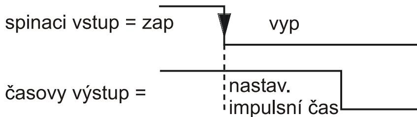
**Prodlení:** Spínací signál na spínacím vstupu bude předána na výstup teprve po uplynutí času časovače. VYP-Signal na Trigger vstupu způsobí okamžité vypnutí výstupu.
