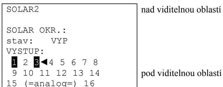
Tímto by *SOLAR 1* s výstupem 1 (jen s čerpadlem) řadil první solární okruh a *SOLAR 2* s výstupem 1 a 3 (čerpadlo a ventil).
