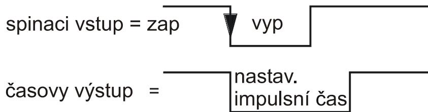
**Nestabilní:** Přes zadání spínacích a vypínačích časů vznikne generátor impulsů bez vstupu časovače. Bude-li poměr dodatečně použit k řízení, změní se čas zapnutí. Zvláštní případ je nastavení vypínačového času = 0: Spínací čas odpovídá potom celkové periodě a poměr vztahu mezi spínacím a vypínačovým časem.
