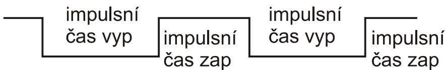
**Impuls:** Při dosažení zvoleného spouštěče bude výstup sepnut na čas časovače. Změna stavu Trigger vstupu během doby impulzu nezpůsobuje žádné změny výstupního stavu.
