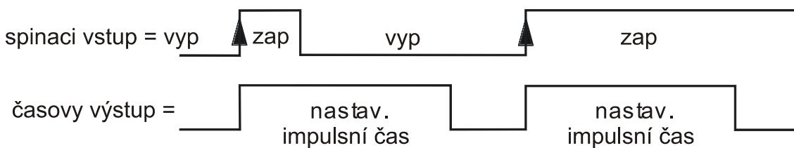
Pozitivní spouštěč je změna vstupního stavu z "VYP" do "ZAP" nebo z "spínač otevřen" na "spínač uzavřeno". Změna z uzavřeno na otevřeno je negativní spouštěč. Se SPOUŠTĚČ změna = poz/neg se dosáhne startu časovače při každé libovolné změně stavu na vstupu.
