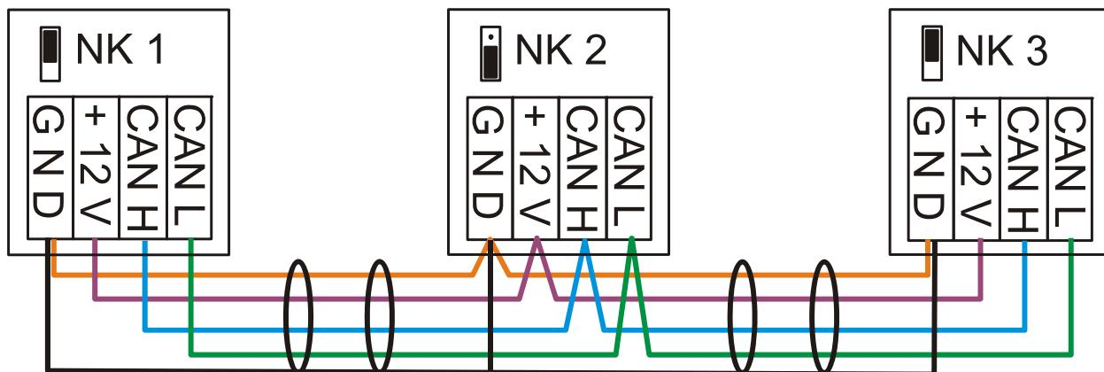
Každá síť CAN je nutno opatřit na prvním a posledním účastníku v síti se  $120 \Omega$  ohmovým ukončovacím můstkom. V sítích CAN jsou tedy vždy použity dva ukončovací můstky. Napíchnutá vedení nebo hvězdicovité CAN-propojení nejsou ze strany oficiální specifikace přípustné!
