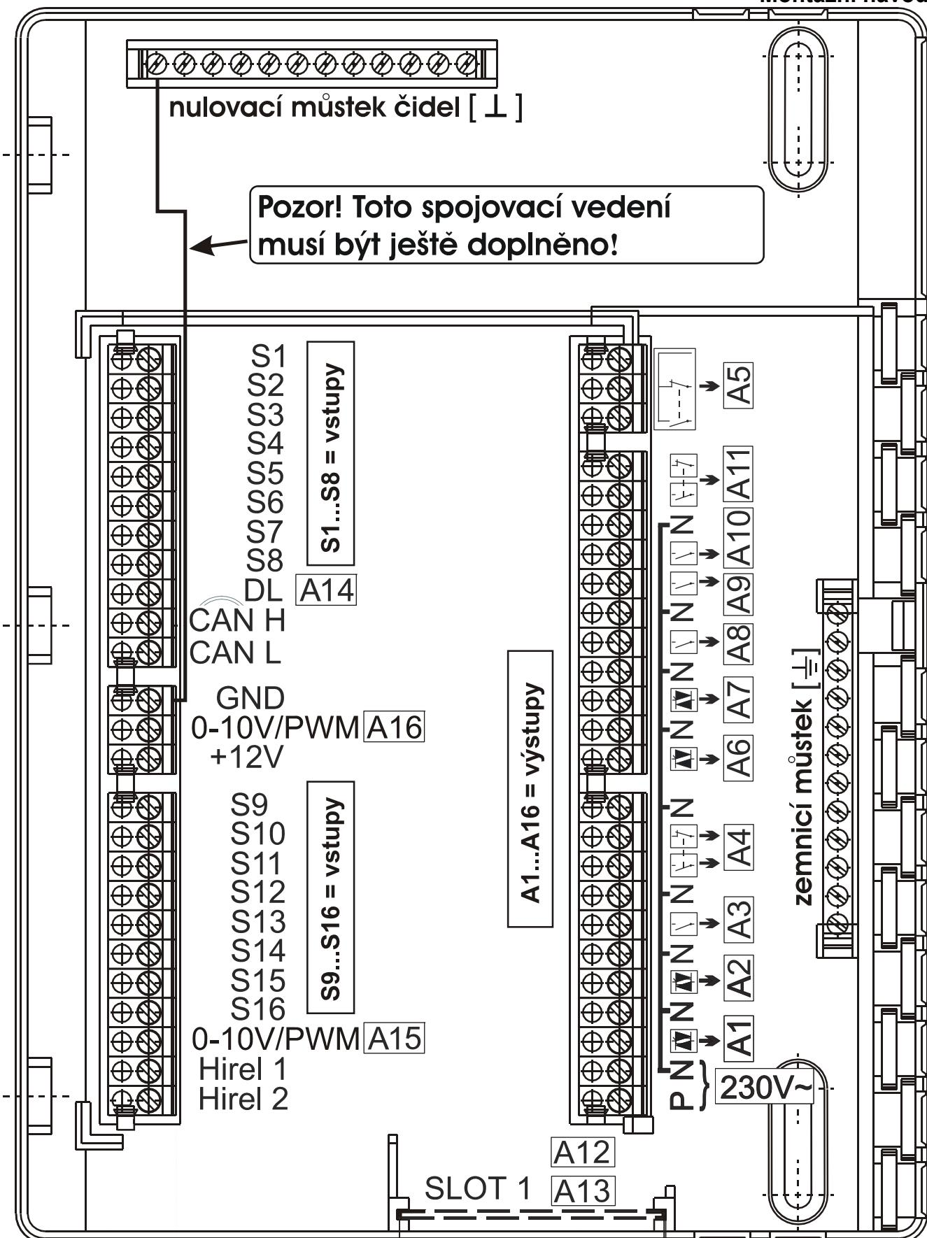
**Pozor:** Výstup A5 je bezpotenciální – tedy není spojen se síťovým napětím.
