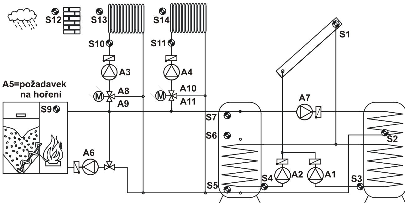
Obsazení čidel a výstupů dle schématu je určeno na základě jejich zvláštních vlastností. Nepoužité čidla jsou:
